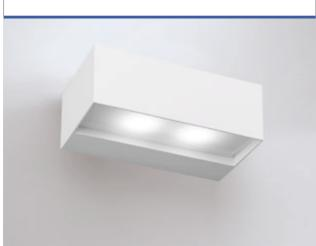
Apparecchio a led per installazione a parete, per interni o esterni, senza viti di fissaggio a vista. Corpo in lamiera di acciaio verniciato bianco. Schermo di protezione in PMMA opale o chiaro. Attacco a muro tipo magnetico.
