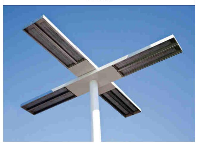
Nuovo apparecchio a led per illuminazione di parcheggi, rotatorie, grandi aree a piazze. Quatto bracci a 90° da 50 a 300W. Distribuzione fotometrica quadrata al suolo. Installazione su testapalo Ø89mm. Corpo in alluminio estruso, anodizzato colore grigio, attacco a palo in acciaio zincato verniciato bianco RAL9010.
